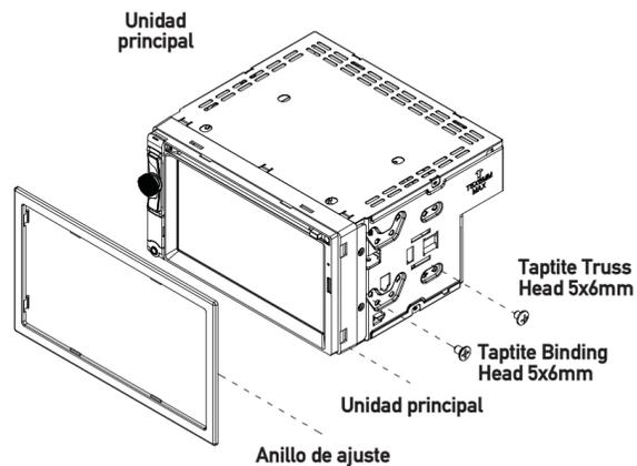
Método de montaje típica de DIN y carga frontal
